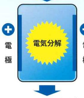
原水に微量の食塩と希塩酸を加えた状態で無隔膜電気分解を行うと、生成された水溶液は水酸化ナトリウム(NaOH)が塩酸により中和され、殺菌力の最も強い"微酸性"領域となり、「次亜塩素酸(HClO)」を主成分とした「微酸性次亜塩素酸水」となります。
